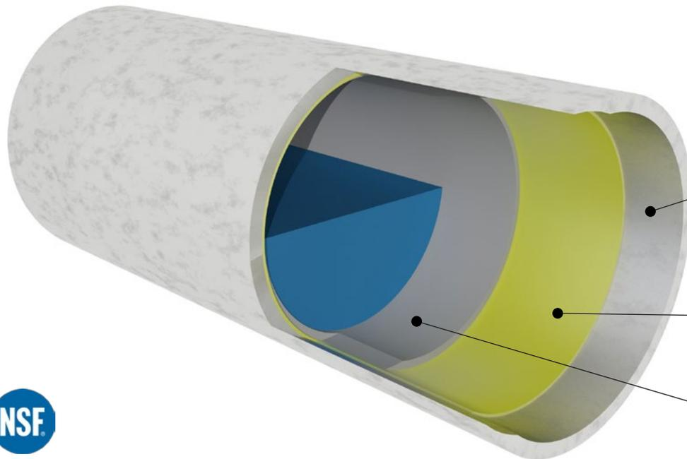
Preparación del soporte. El soporte debe estar limpio y seco. Para ello recomendamos utilizar un proceso de chorreado de arena logrando un SSPC SP-10 o similar. Este proceso provoca una superficie irregular, por lo que la superficie específica se incrementa y la adherencia es mucho mejor.
