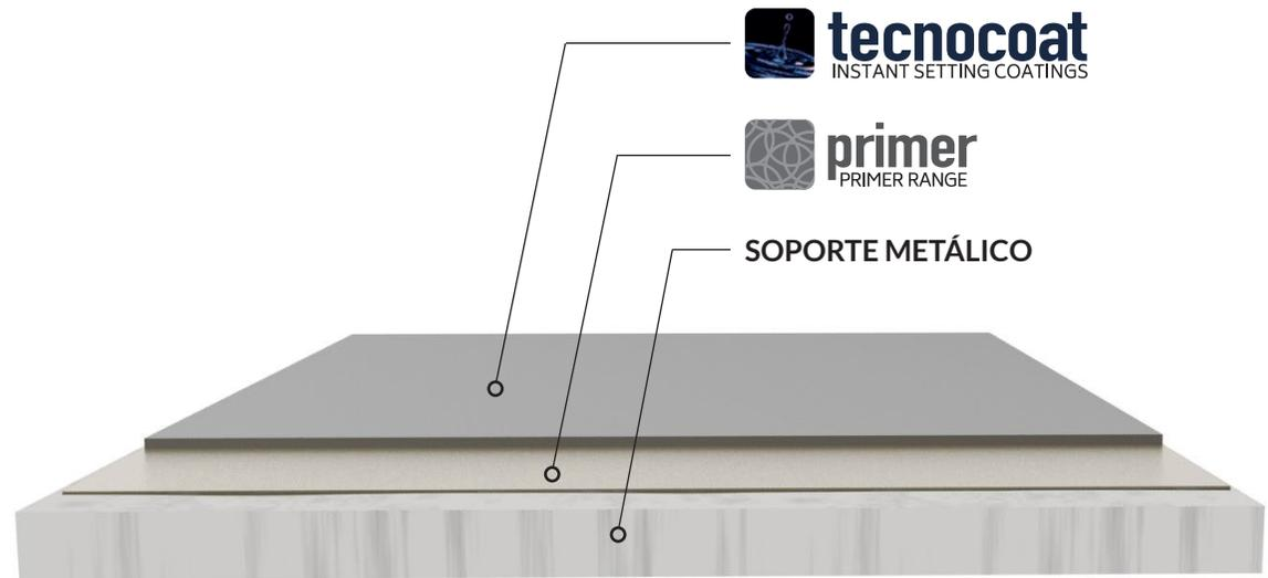
TECNOCOAT P-2049 se adhiere completamente al material protegido, por lo que ninguna molécula de agua o aire puede entrar en contacto con el material protegido.
