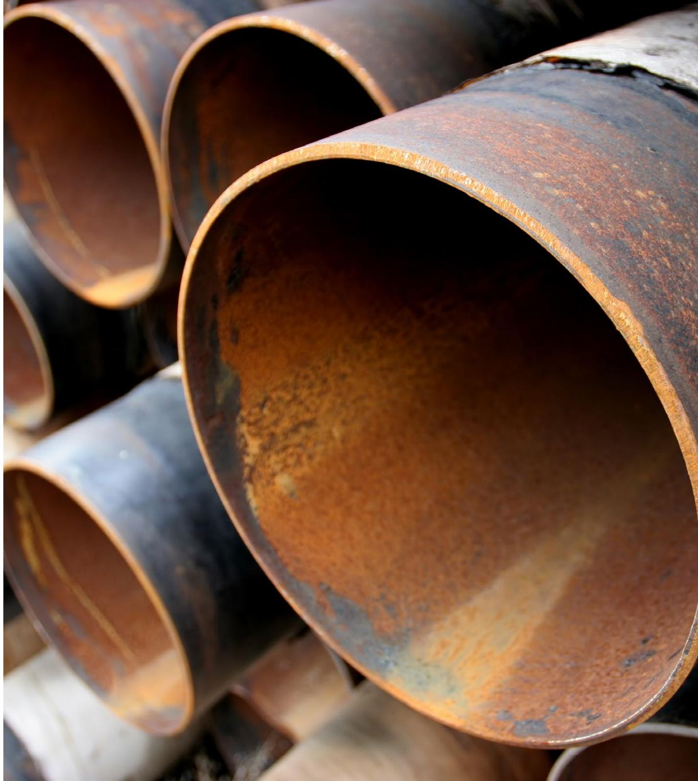
Existen varios métodos para prevenir la oxidación, pero el más efectivo es cubrir el material a proteger con una capa impermeable y totalmente adherida que impida el contacto con el aire y el agua.
